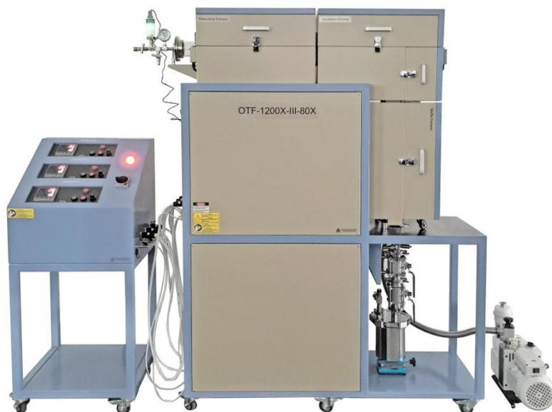
OTF-1200X-III-80X 升华系统如图所示。炉衬使用真空成型高纯氧化铝聚轻材料，采用电阻丝为加热元件。石英管横穿于炉体中间作为炉膛，炉管两端用不锈钢法兰密封，工件式样在管中加热，加热元件与炉管平行，均匀地分布在炉管外，有效的保证了温场的均匀性。测温采用性能稳定，长寿命的“k”型热电偶，以提高控温的精准性。控制柜的控制面板配有三种炉子的智能温度调节仪、控制电源开关、主加热工作/停止按钮，配有工作指示灯，以便随时观察本系统的工作状态。
