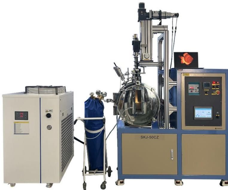
SKJ-50CZ 是顶部籽晶法晶体生长炉，可利用助溶剂法生长各种材料单晶。配备精密旋转提拉机构可用于顶部提拉籽晶助溶剂法生长各种晶体材料，提拉和旋转速度采用 PLC 触摸屏控制，操作简单。采用感应加热，最高温度可到达 1200℃，24 段可编程控制器，可根据不同的客户需求来设定升降温程序。配备精密旋转提拉机构可用于生长各种晶体材料，提拉速度和旋转速度均可根据客户要求定制。
