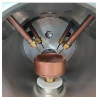
SKJ-ARC-CZ 是一款单晶生长炉，4 个电弧熔炼腔安装在真空腔体上，一个旋转提拉机构安装在设备上。此款单晶生长炉用于熔点特别高的材料进行单晶生长，设备对样品熔炼温度可达 3000℃
