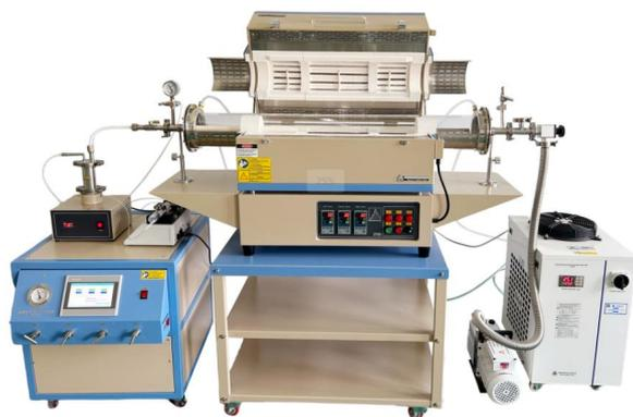
超宽带隙氧化物晶圆雾化生长设备 OTF-1200X-III-S-MCVD  $\phi$  130 主要是由三温区管式炉、雾化装置、真空机组以及供气系统等组成。该设备可将溶于液体的物料通过超声雾化装置雾化输送至炉管腔室内，再通过供气系统创建腔室内部气氛环境（达到操作需要的气氛环境），然后以此气氛环境操作管式炉加热等，烧结炉管内样品材料。（图片仅供参考，请以实物为准）
