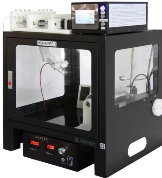
MSK-NFES-1U 是一款多功能静电纺丝机。此产品设计易于用户操作而且价格便宜。MSK-NFES-1U 配置 2 个 5 通道 (2×5=10) 注射泵, 可同时安装 10 个注射器喷头, 达到喷头纺丝机提高实验效率。配置同轴喷头可与 2 个注射泵结合体纺织除内部和外层材料不同的纤维丝。高压电源可输出电压范围为 0-30KV, 最大电流为 1mA。配有 2 种纤维丝收集器: 一个滚筒收集器和一个平板收集器。
