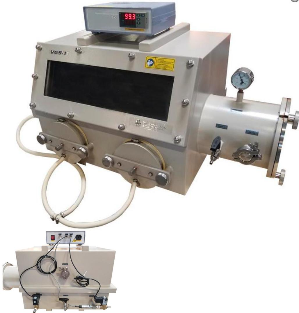
VGB-1-KJT 是一款小型的不锈钢手套箱，带有一个前级室，气压表，和真空密封法兰。可通过抽真空移除手套箱内的水氧，不需要价格昂贵的气体净化系统。一个自动气压控制系统，能够自动地稳定手套箱内的气压。此款设备适合处理各种水氧敏感性材料。
