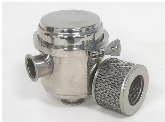
不锈钢高真空泵前级颗粒过滤器适用于对真空漏率要求高(真空度高)的工作条件,安装于真空泵进气口,对吸入的粉尘颗粒物进行过滤,减少较大的颗粒物吸入泵腔而造成真空泵泵腔或真空泵油受到污染,减少泵腔机械磨损,延长真空泵使用寿命和保养周期。外壳采用 304 不锈钢无缝焊接,具有良好的耐腐蚀性能及密封性能,
