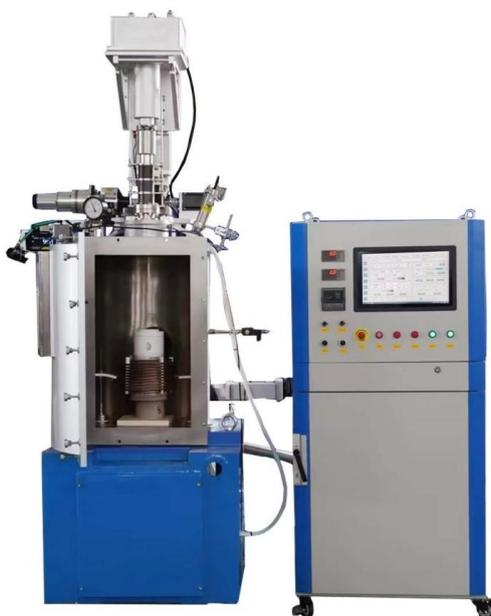
SKJ-50CZ 是一款高真空上称重 CZ 法晶体生长炉，最高温度可达2100℃，单晶生长尺寸为2英寸，配有高精度在线称量装置，称量装置位于提拉机构上部，最大称重 5Kg，精度 0.1g；带有快慢速切换的高精度提拉机构，最慢提拉速度可保证 0.03mm/h；配有中/高频切换复合感应电源，以满足不同材料融化工艺，全不锈钢水冷腔体，搭配分子泵，最高真空度可达  $5.0 \times 10^{-3}$ Pa，此款晶体生长炉已经被证实可以制备各种氧化物单晶、金属单晶以及各种 CZ 法适用的体系材料，如蓝宝石、GGG, YAG, LaAlO<sub>3</sub>, Si 和 Ge, Cu 等。
