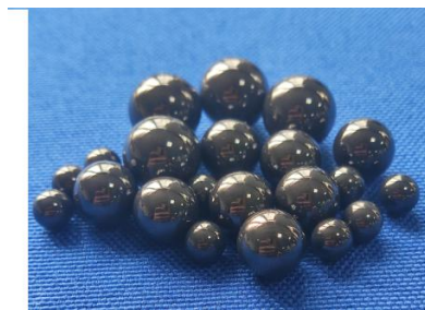
Si3N4 罐&球 合肥科晶摆振球磨机 1000RPM,60 分钟
