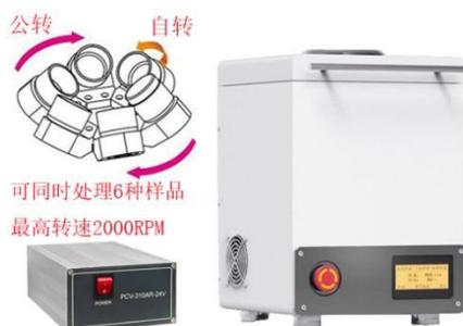
MSK-PCV-30 是一款高能离心式行星混料/球磨机（最大离心加速度 438g），可在真空环境下同时处理 6 种不同的材料，每个工位罐体的最大容积是 30ml。
