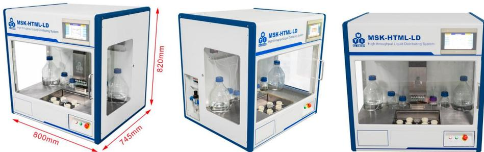
MSK-HTML-LD 是一个小型自动液体分配系统，可以应用于高通量实验液体分配。PLC 控制系统允许用户轻松配置编程步骤，并记录数据。
