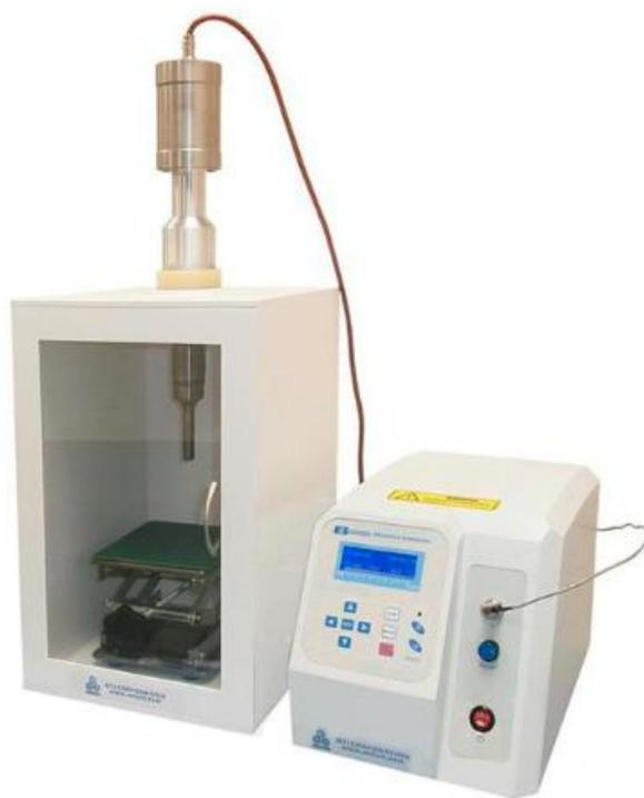
MSK-USP-3N 是一款桌面式 300W 超声处理器，配有一个隔音腔和不锈钢升降台。此款设置主要用于分散液体中的纳米粉体，使液相中的共沉积状态到均质化，也可将多种化学物质进行高质量混合。此款超声处理器特别适合于用溶胶凝胶法制备新一代 LED 荧光粉，锂电池浆料等。
