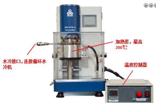
MSK-SFM-16 是一款小型的双轴行星真空搅拌机。相比较与单轴搅拌机，双轴搅拌使浆料混合更加均匀，而且可设置 3 段搅拌程序。设备内部安装了真空泵，可在搅拌过程中排出浆料中的气泡，真空度可达到-0.08MPa。设备中标配一个 150ml 的不锈钢罐，可选购 50 和 500ml 搅拌罐，（可选购加热型搅拌罐，最高温度 200℃）。此款小型搅拌机可通过手套箱过渡仓进入手套箱内使用（Ar 和 N2 环境）。
