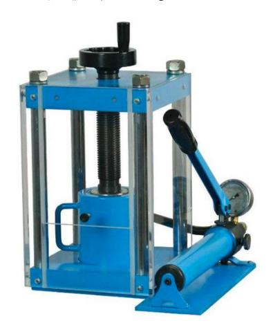
YLJ-24T 是一款实验室小型压机,最大压力 24T,用于材料/化学实验探索,可制备复合陶瓷样品。YLJ-24T 安装了一个透明的防护罩,手动液压泵与压机主体分开,特别便于设备维修和液压泵更换。
