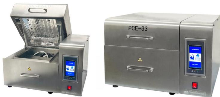
PCE-33 是一款桌面式紫外（UV）臭氧清洗机，自动开/关样品门，可选加热样品台，可用于清洗各种基片来达到比较好的涂膜/镀膜效果，最大有效清洗面积 300×300mm。此款设备特别适合移除基片上的光刻胶，改善润湿性，清洗钙钛矿太阳能电池基片，SEM&TEM 样品，UV 聚合物改性等。紫外臭氧清洗已被证明了是一种无酸性，干燥且无损伤地原子级别清洗手段，特别适合清除样品表面的有机物。设备上所用紫外灯管主要发出 2 种波长的紫外光 185nm 和 254nm，其中 185nm 紫外光可把空气中的氧变为臭氧，254nm 紫外光激活基片表面的有机物分子，两者结合可有效清除基片表面有机物。
