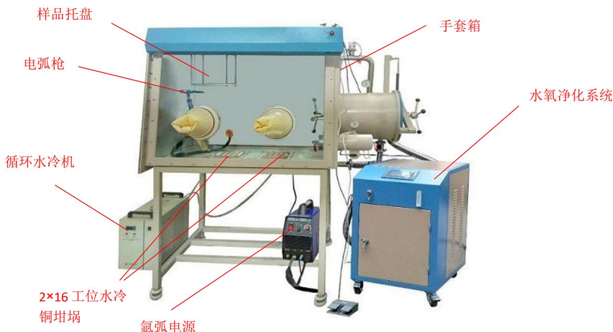
SP-MAM-32 是一款 32 工位手动操作电弧熔炼系统（在手套箱内操作）。2 个 16 工位水冷坩埚安装在手套箱内，手套箱内的 H<sub>2</sub>O&O<sub>2</sub><1ppm。客户可以用电弧枪对每个工位的样品进行电弧熔炼，温度可达 3000℃。与传统电弧熔炼炉，此套熔炼系统大大节约了整体实验时间：熔炼前样品放置时间，抽真空和通 Ar 气的时间。此套设备特别适合运用于高通量方法来探索性一代合金材料。
