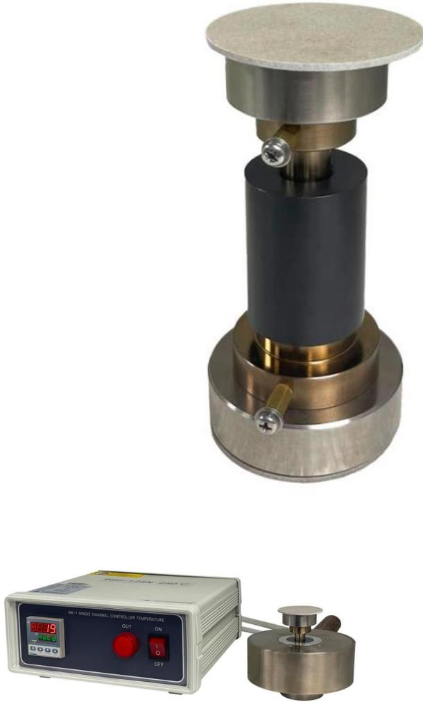
PSC-SiN 是一款固态扣式电池测试池，模套采用氮化硅制作（Si<sub>3</sub>N<sub>4</sub>），可在高温环境下进行固态电池电性能测试，最高温度 400℃，模芯直径可选 12mm 或 20mm。此套测试模具也可放在加压装置内进行加压，最大可承受 100MPa。可在高温和压力环境下进行测试。这款产品设计是为了研究压力和温度对固态电池性能的影响。
