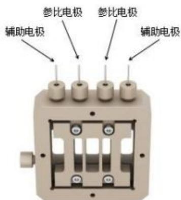
SPC-MC 是一个可拆卸/组装式测试池，有 2 电极或 4 电极结构，用于测试固态薄膜离子电导率。
