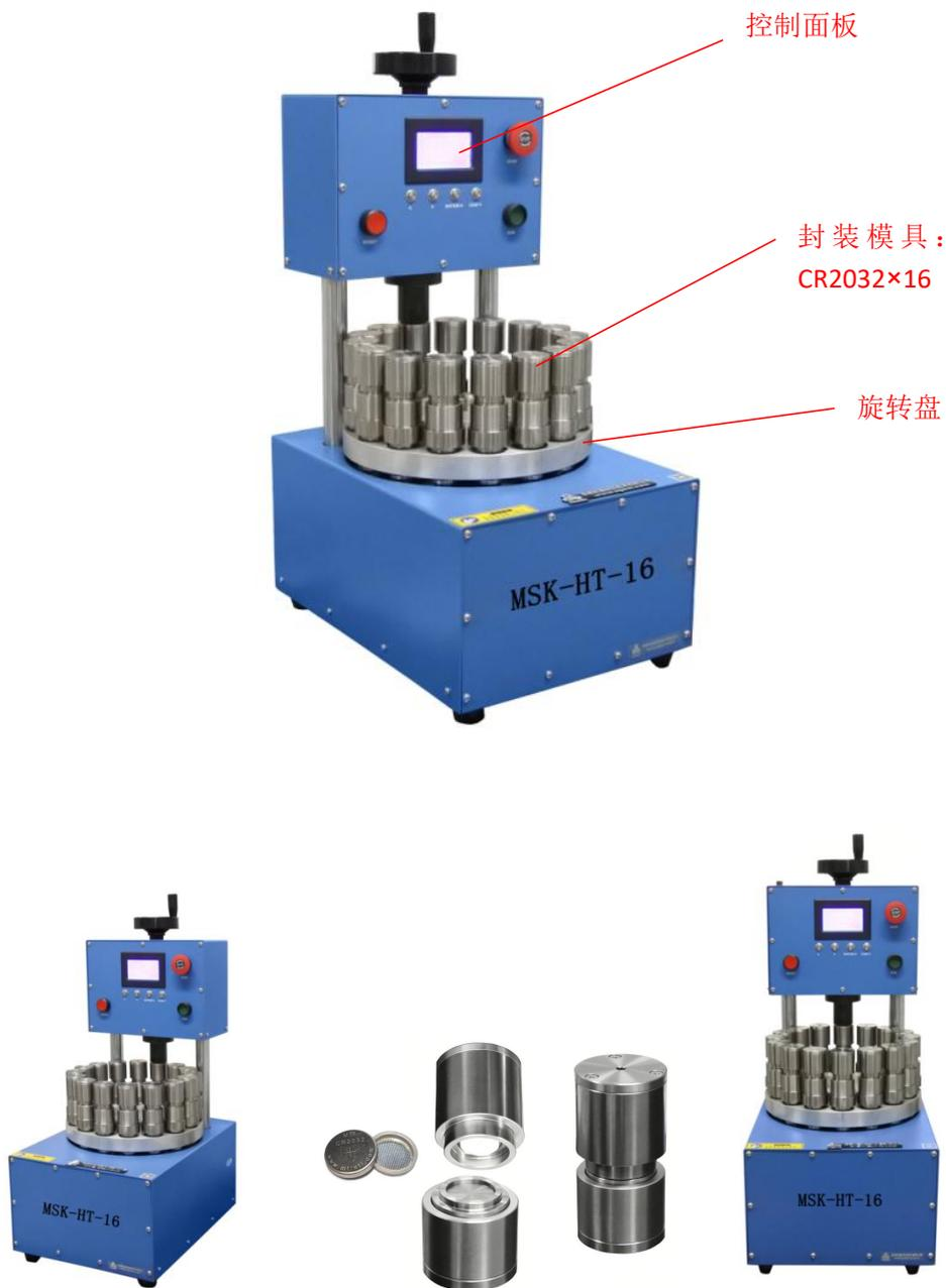
MSK-HT-16 是一款高通量 16 工位压力可控型电动纽扣电池封装机，可封装
