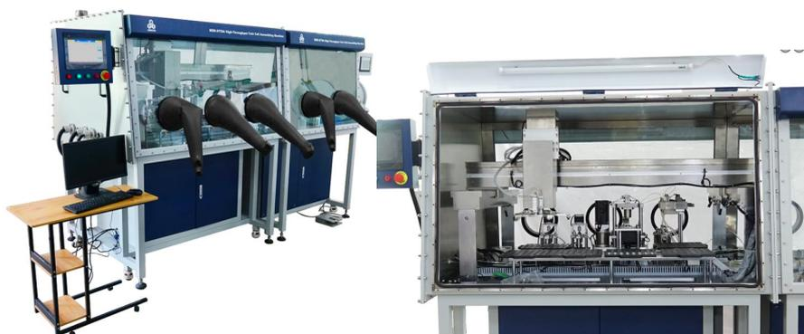
MSK-HTBA 是一款自动扣式电池组装系统，用于采用高通量方法来研究电池材料，可拿去 8 种电池阴极和阳极和 2 种电解液，进行组装电池，64 个电池/小时。这个设备运行都在手套箱里，可达到环境控制。
