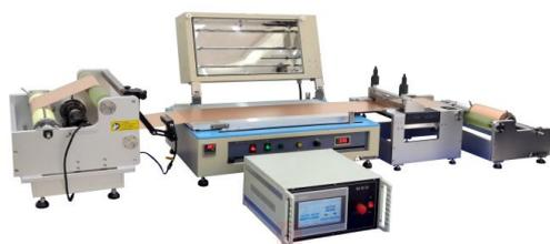
MSK-RR-350 是一款自动卷对卷系统，带有自动张力控制盒纠偏系统，最大上卷宽度 350mm。此款设备涂布适合和本公司单片涂布机（MSK-AFA-L1000）配合，DIY 卷对卷涂布机。
