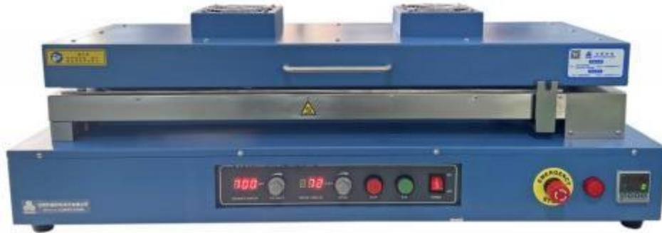
MSK-AFA-L800BH 是一款通过 CE 认证的小型流延涂布机，带有底部加热功能，其温度可达 100℃，顶部安装有排风装置，可将挥发的气体排出。此款设备特别适合于制作高温聚合物膜和导电陶瓷薄膜等。
