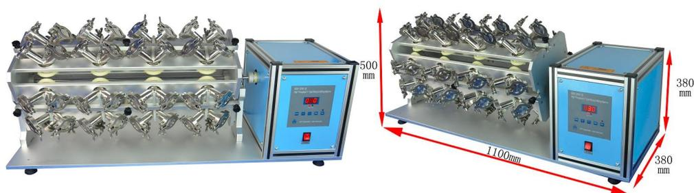
MSK-SFM-32 是一款高通量混料和球磨机，可安装 32 个容积为 50ml 的不锈钢罐，可同时对 32 组样品进行处理。罐体采用独特的 V 型设计，用于细化和混合干粉。一个数字控制面板设置转动速度和时间。混料机也可在 Ar 环境下的手套箱内使用，用于处理一些空气敏感性材料。
