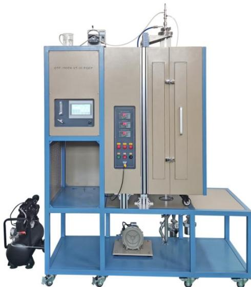
OTF-1200X-VT-III-PGEP 是一款多功能的合成系统，针对于合成各种纳米结构氧化物以及纳米材料的复合包覆工艺。此款仪器有三个主要模块组成：气雾化装置、1200℃三温区立式管式炉和收集装置组成。材料制作大概分为三个步骤：前驱体雾化、加热和纳米颗粒收集。此款系统是一款非常先进的合成系统，可控制器颗粒尺寸，形态，微纳米结构等，可广泛应用于纳米材料制备、电极材料包覆复合等方面。
