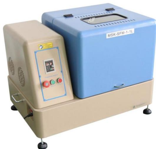
SFM-1-1L 是一款行星球磨机，转盘上可装 4 个混料罐，每个混料罐的容积为 1L，当转盘转动时，混料罐中心轴作行星运动，罐中磨球在高速运动中研磨和混和样品。该产品能用干、湿两种方法粉碎和混和粒度不同，材料各异的产品，研磨产品最小粒度可至即（ $1.0 \times 10^{-4}$ mm）。广泛应用于地质、矿产、冶金、电子、建材、陶瓷、化工、轻工、医药、环保等部门。
