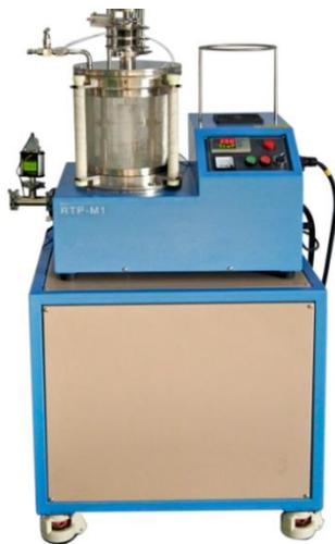
RTP-M1 是一款小型的桌面式超快速高真空热压炉，压力可调节。有手动和自动两种加热方式，最高温度可达 2900℃，加热速率可达 200℃/s。它是一款在快速加热和快速降温条件下研究材料性能的设备。
