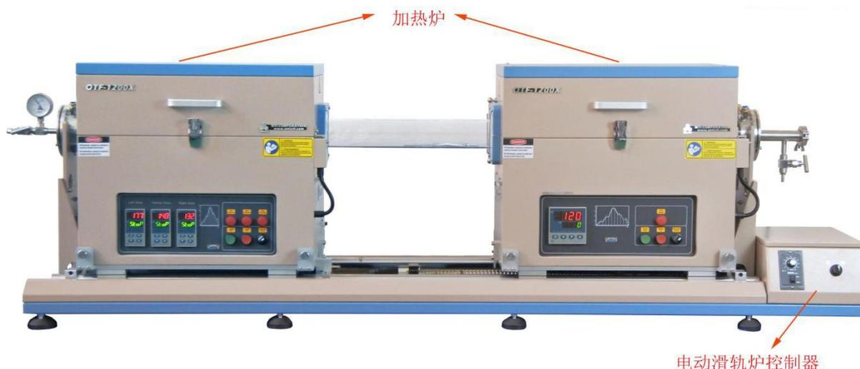
OTF-1200X-80-DFSL 是由两个管径 80mm 开启式管式炉组成，最高温度 1200℃，用于生长 2D 材料，左边炉子固定用于升华（也可手动滑动），右边炉子采用电动方式滑动炉子，可实现快速加热沉积和快速冷却，两个加热炉都有独立控温系统，升华和沉积可以设置不同的温度，可用于二维过渡金属硫化物(TMDC)单层膜的制备。
