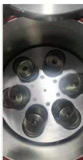
MSK-PCV-30 是一款高能离心式行星混料/球磨机（最大离心加速度 438g），可在真空环境下同时处理 6 种不同的材料，每个工位罐体的最大容积是 30ml
