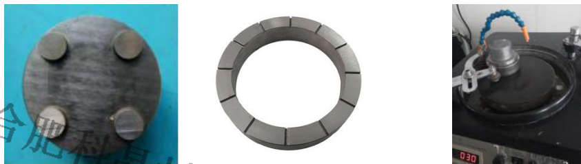
图 8 装配好试样的载物盘及载物盘外套的修盘环
