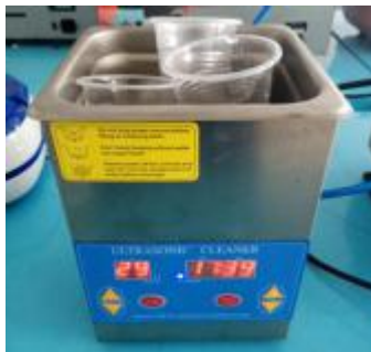
图10 清洗试样中的超声波清洗机
